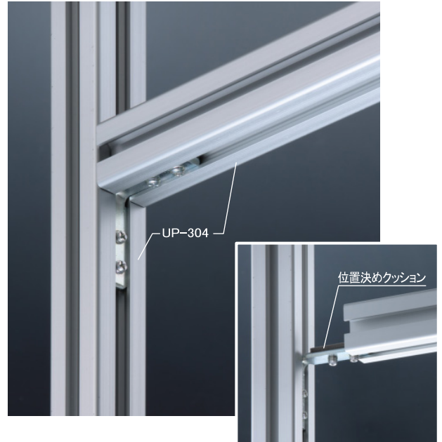
[位置決めクッションあり (UJ-40P,30P,43P)] 位置が変わることなく、止めねじを 締め付けできます
