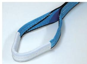
アイ部分は、細く絞って縫製し、フックへの掛けはずしを容易にするとともに、ナイロン製保護反による補強により耐久性を高めています。
