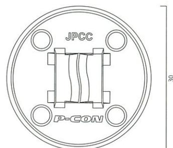
ドリル、ビス、釘などを使用せず、エポキシ系接着剤や変成シリコン系接着剤による施工を行うのでマンションやビルの壁面、高架橋といった建物を傷付ける心配なく使用できます。
