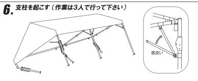
奥行方向の3本支柱を、同時に起こします。その後、筋交いを固定し、 (筋交いを固定した側の)天幕をフレームに固定します。
