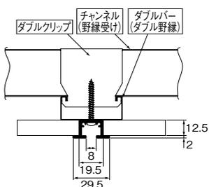
天井先付 (補強プレート使用時)
