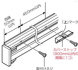
③フロントカバーをベース上部に引っ掛け、②で取付けたカーブストップの位置を押してベース側に取付けてください。
