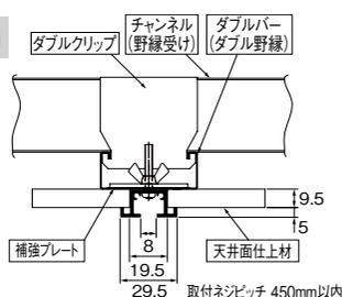
C型鋼+吊りボルト
