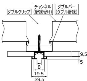
天井先付 (補強プレート使用時)
