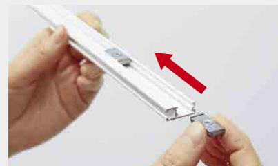
レール裏面の溝に、マグネットブラケットをスライドして挿入してください。プラスドライバーで固定してください。
