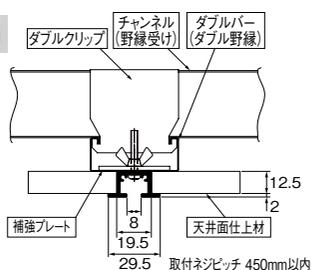
C型鋼+吊りボルト
