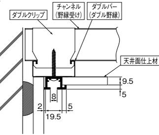
天井先付 (補強プレート使用時)
