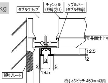
C型鋼+吊りボルト
