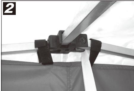
横幕をお好みの高さになるように合わせ、横幕上部のマジックテープをフレームのトラス部分に巻き付けます。
