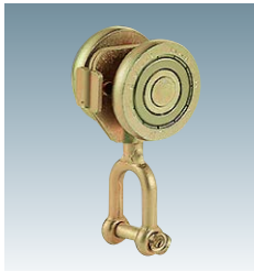
#2シャックル付単車2型 #2 2WHSY2 質量20kgまで (1個吊当り)
