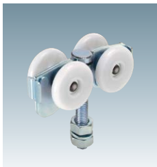
MTH2トローリー複車 MTH2-4WHTR 使用荷重35kg/個で走行距離5万m 使用荷重25kg/個で走行距離10万m
