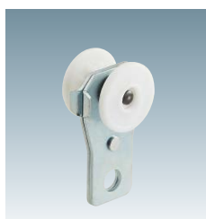
MTH2ツール単車 MTH2-2WHTU 使用荷重25kg/個で走行距離5万m 使用荷重15kg/個で走行距離10万m
