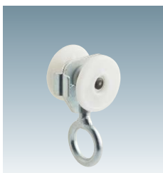
MTH2リング付単車2型 MTH2-2WHL2 使用荷重25kg/個で走行距離5万m 使用荷重15kg/個で走行距離10万m
