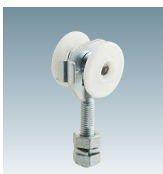
MTH2単車2型 MTH2-2WH2 使用荷重25kg/個で走行距離5万m 使用荷重15kg/個で走行距離10万m
