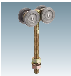
複車 ロングボルト仕様1 #2 4WH-1LB 質量70kgまで(2個吊当り)
