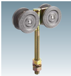
複車 ロングボルト仕様1 #4 4WH-1LB 質量300kgまで(2個吊当り)
