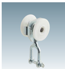
MTH2シャックル付単車2型 MTH2-2WHSY2 使用荷重25kg/個で走行距離5万m 使用荷重15kg/個で走行距離10万m
