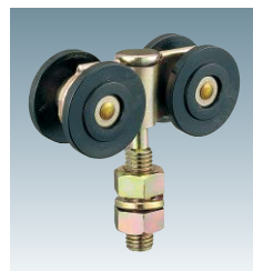
防音複車 #3 4WH-QN 質量150kgまで(2個吊当り)
