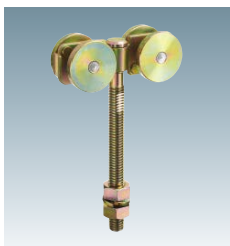
ベアリング複車 [フレキシブルタイプ] ロングボルト仕様1 #2 4WH-BN-1LB 質量70kgまで(2個吊当り)
