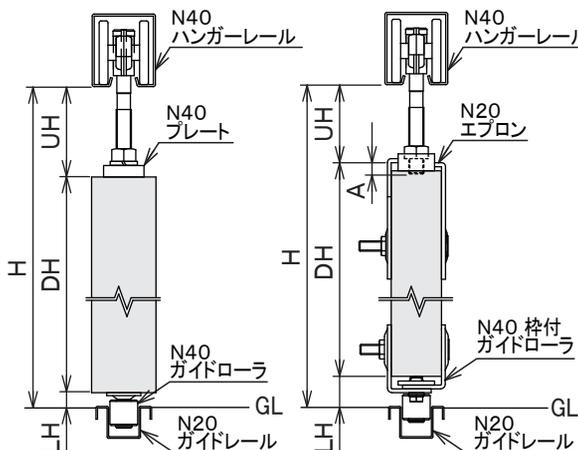
UH = ハンガーレールの下端と扉の上端との間の隙間寸法
