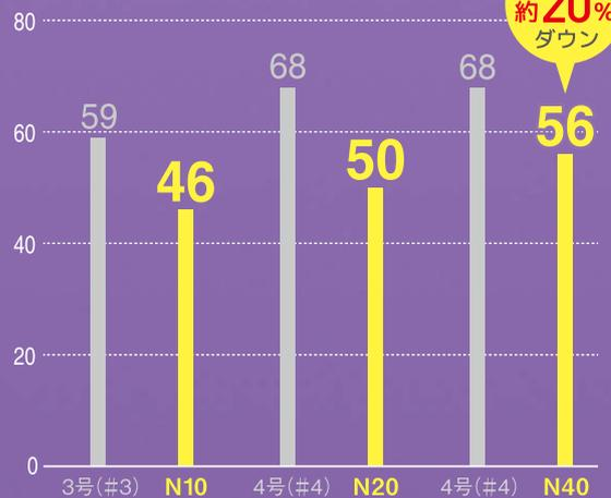
※測定値の扉重量(複車2個吊り)…980N(質量100kg):スチール3号(#3)、N10/1470N(質量150kg):スチール4号(#4)、N20/2940N(質量300kg):スチール4号(#4)、N40
