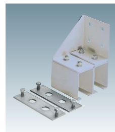
N20横継受二連 N20-SBT2 ●材質:SS400 (粉体塗装仕上げ マンセル記号N7)、他 ●レールとレールの接続部分に使用します。(P.31 参照) ●レールの連結プレートが付いています。 ●座とボックスの組付ボルトはM8 ●推奨取付ねじ:M10
