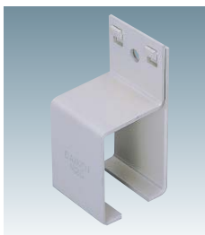
N20横受一連 N20-SB ●材質:SS400 (粉体塗装仕上げ マンセル記号N7)、他 ●横継受一連と取付穴位置が異なります。 ●推奨取付ねじ:M8
