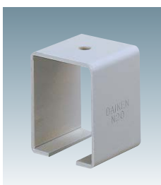
N20天井受下 N20-BOX ●材質:SS400 (粉体塗装仕上げ マンセル記号N7) ●推奨取付ねじ:M8 ※サイドカバーを使用する場合、ボルト頭5.5mm以下をお使いください。
