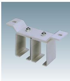
N20天井受二連 N20-OB2 ●材質:SS400 (粉体塗装仕上げ マンセル記号N7)、他 ●ハネとボックスの組付ボルトはM8 ●推奨取付ねじ:M10
