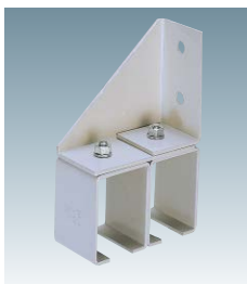
N20横受二連 N20-SB2 ●材質:SS400 (粉体塗装仕上げ マンセル記号N7)、他 ●座とボックスの組付ボルトはM8 ●推奨取付ねじ:M10
