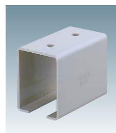
N20天井継受下 N20-TBOX ●材質:SS400 (粉体塗装仕上げ マンセル記号N7) ●レールとレールの接続部分に使用します。 ●推奨取付ねじ:M8
