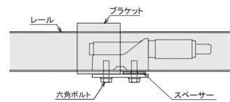
2: ブラケットの位置にくる場合は、スペーサーを レールと押さえ板の間に入れて六角ボルトで 締め付けます。
