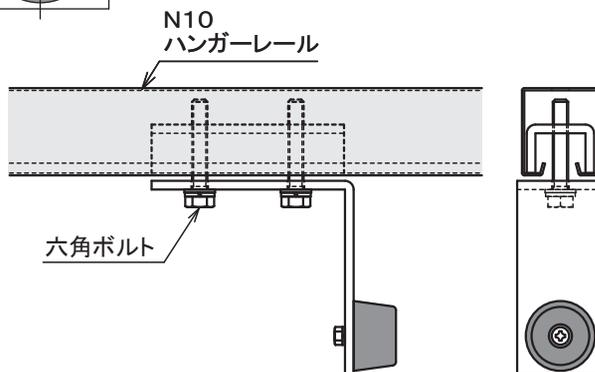
2: ブラケットの位置にくる場合は、スペーサーをレールとL型金具の間に入れて六角ボルトで締め付けます。
