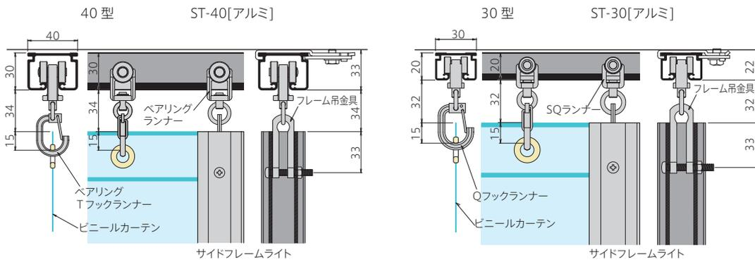
**片開き用アルミ枠【取付け方】**
