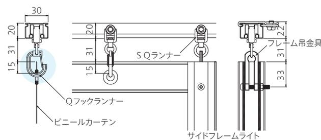
サイドフレイム・中間フレイムの丈(長さ)/ST-30レールを天井シングルブラケットで固定する場合
