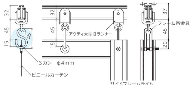
サイドフレイム・中間フレイムの丈(長さ)/アクティ大型レールを天井シングルブラケットで固定する場合
