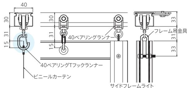
サイドフレイム・中間フレイムの丈(長さ)/ST-40レールを天井シングルブラケットで固定する場合
