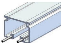
もう一方のレールをピンの長い方に挿し込んだ後、短い方に挿し込む。
