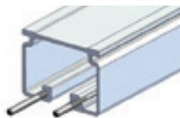
段違いに挿し、ギザギザ部を半分打ち込む
