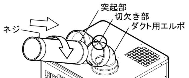
※冷風ダクトは、エルボ側に近いところを持って取付けてください。ネジ側を持って冷風ダクトを回すと、冷風ダクトがやわらかくなり垂れ下がる可能性があります。
