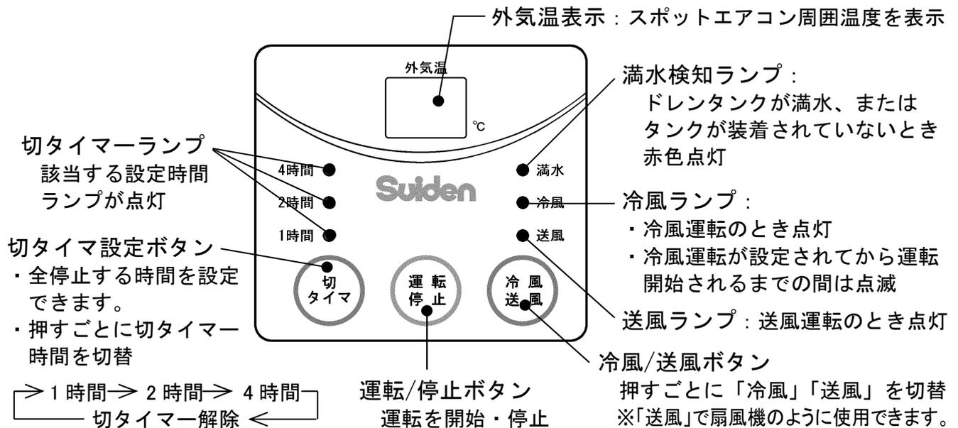
**注記** 「冷風」運転から「停止」または「送風」運転に切替えて、すぐ「冷風」運転にしたときは、コンプレッサー保護のため、約3分間は冷風運転を行いません。コンプレッサーの停止と起動の間隔は、できるだけ3分以上の時間をとるようにしてください。
