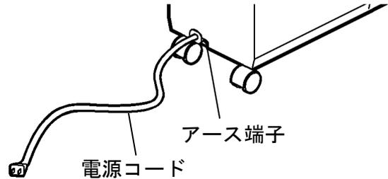
**注記** 電気工事およびアース工事は、電気事業法および同法省令“電気設備に関する技術基準”に従い、一般社団法人日本電気協会制定の“内線規程”を参考にしてください。
